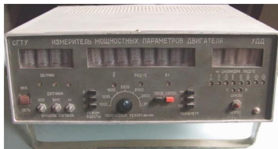
Рисунок 4. Устройство для поэлементного диагностирования систем и механизмов ДВС
