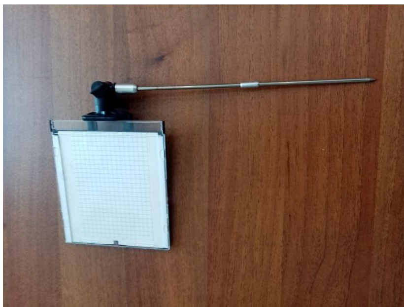
Рисунок 1. Внешний вид держателя для фиксации листа растения
