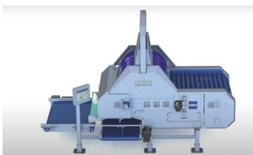
Рисунок 2. Автоматическая опико-электронная установка Oculus
