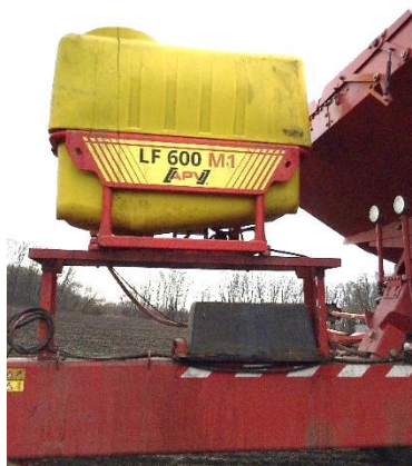
Рисунок 3. Общий вид устройства для внесения жидких удобрений LF 600 M1
