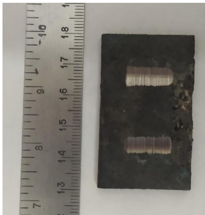
Рисунок 3. Общий вид образца с зоной изнашивания
