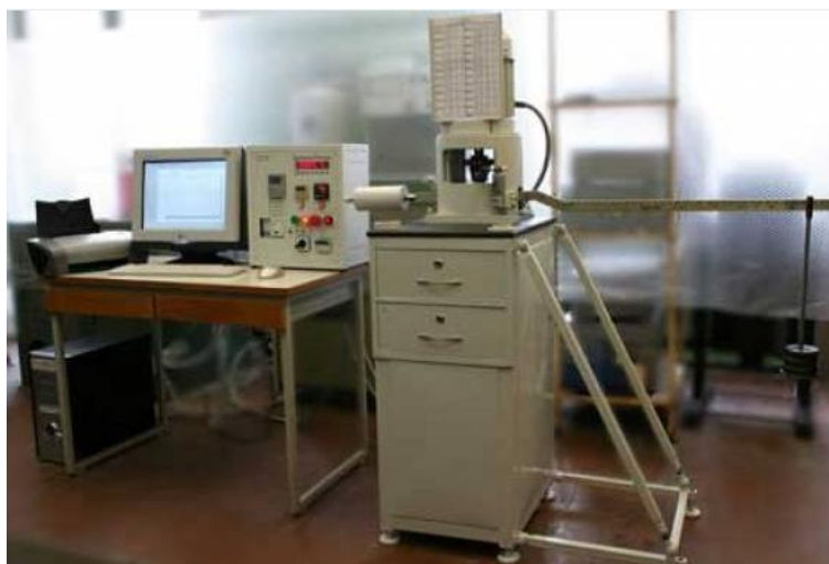
Рисунок 1. Четырехшариковая машина трения ЧМТ-1
