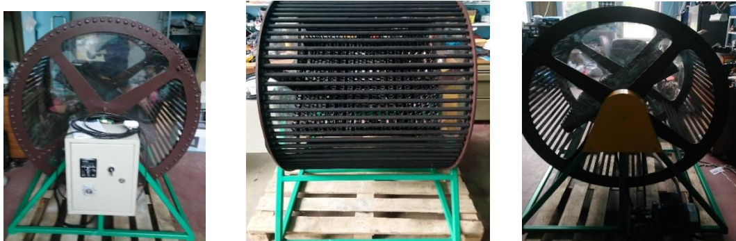
Рисунок 1. Общий вид макетного образца устройства для оценки пригодности сортов и гибридов к механизированной уборке
