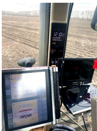
Рисунок 2. Общий вид ISOBUS терминала модели IsoMatch Tellus
