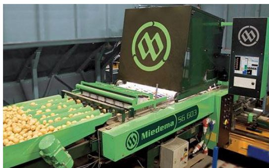
Рисунок 1. Установка электронная сортировочная (Miedema Smart Graders)
